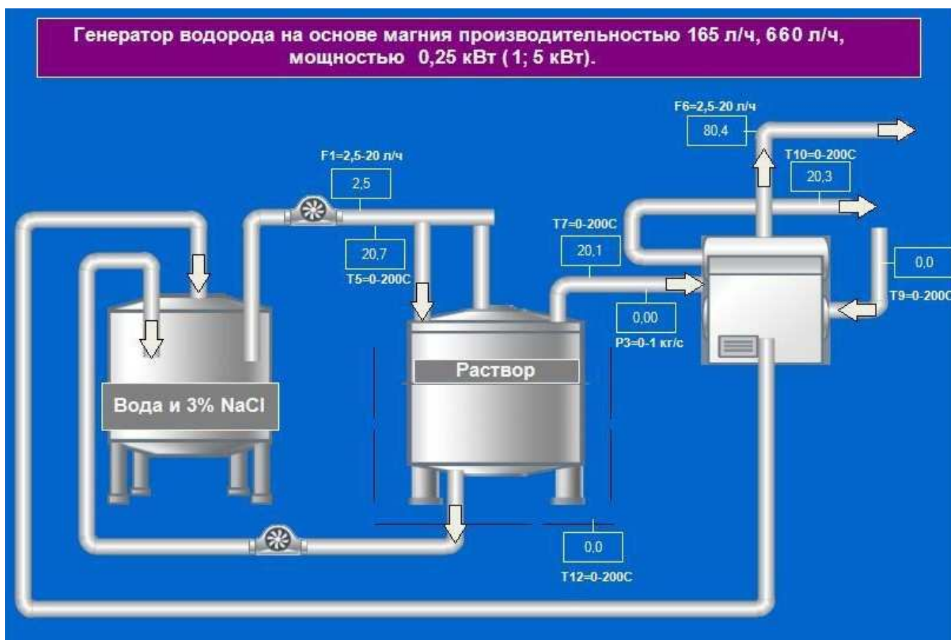
Рис.5. Мнемосхема генератора водорода, отражающая динамику изменения параметров отдельных частей генератора.
