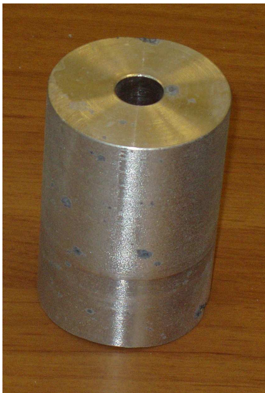
Рис. 2. Демонстрационный образец картриджа генератора водорода на основе гидрореагирующего сплава магния.
