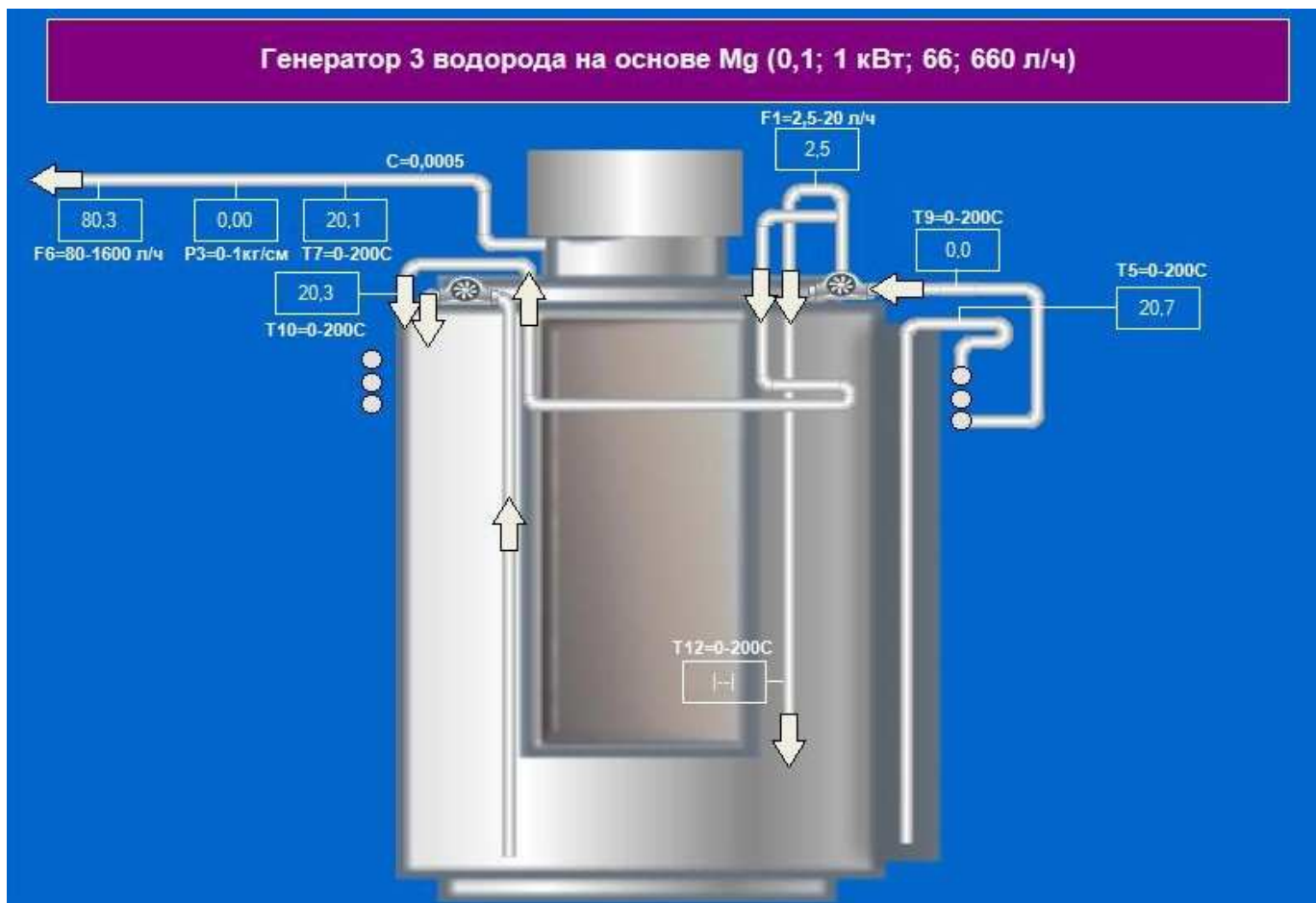
Рис.6. Мнемосхема генератора водорода, отражающая динамику изменения параметров процесса для генератора в целом.
