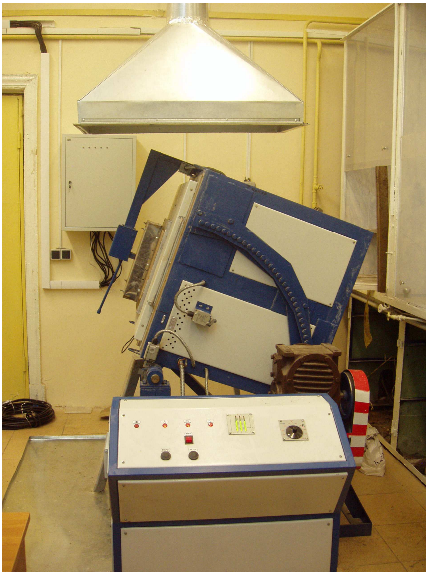
Рис.1. Фото плавильной печи.
